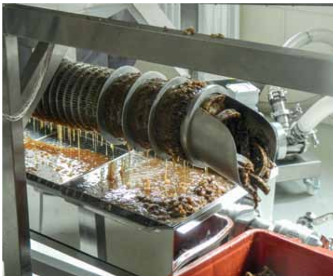
Šnek oddělující vosk z odvíčkování od medu
