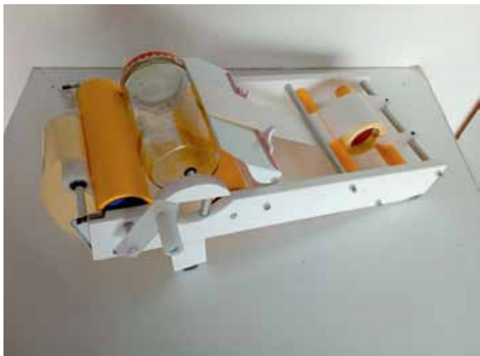
Etiketovačka – Ruční etiketovačka umožňuje přesné umístění etikety na sklenici
