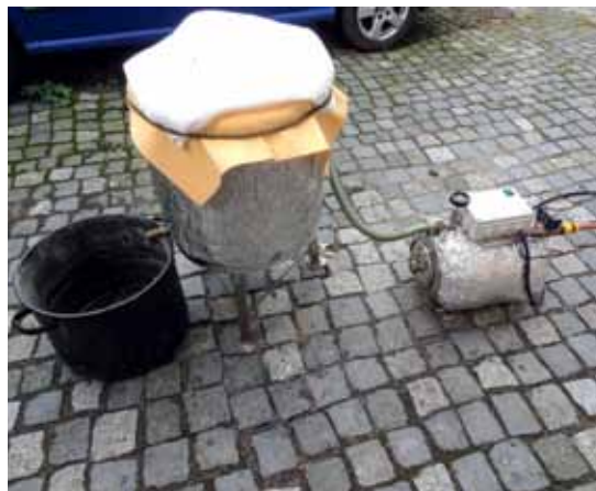
6. Používám parní duplikátor jako separátor s vyvíječem o výkonu 5 kW
