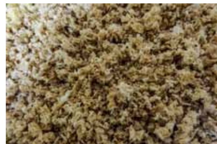
5. V sudu zbydou opraná víčka, jsou sypké konzistence, nasypu je do pytle z uhelonu a umístím do parního separátoru
